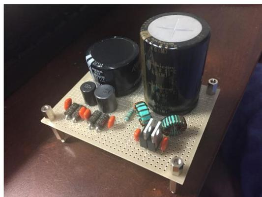
側には、電流が大きいので入れていない。SN8S-300 が入れられるのは、せいぜい 10W 級のアンプまで。もっと、電流容量の大きなコイルを使えばできなくはないが、サイズが大きくなるので入れていない。
