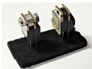
2SJ78 はクリップ止めで熱結合していたが、凸型絶縁ワッシャーと 0.8mm 厚の絶縁ワッシャー 4 枚を使ってねじ止めする方法に変更した。
